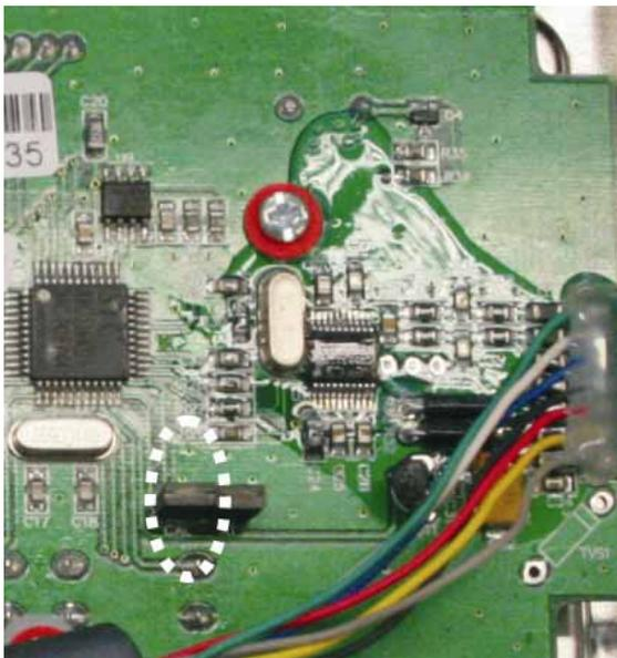
⇒ Zur Justierung / Zugang zum Konfigurationsmenü muss der Jumper „CAL“ auf der Leiterplatte gesteckt sein.
