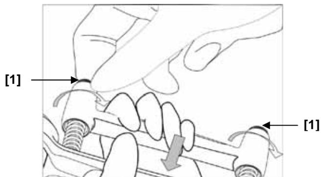
1. Gerät zusammenpressen bis die zwei Schrauben [1] sichtbar werden.
