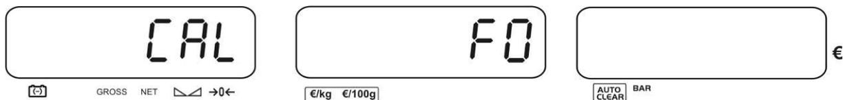
3. Die erste Funktion „F0 CAL“ wird angezeigt. Justierschalter drücken.
