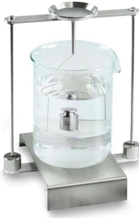
Abb.6: Wägung in Prüfflüssigkeit
