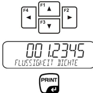
Eingabe mit **PRINT**-Taste bestätigen, die Waage wechselt in den Modus zur Dichtebestimmung von Feststoffen.
