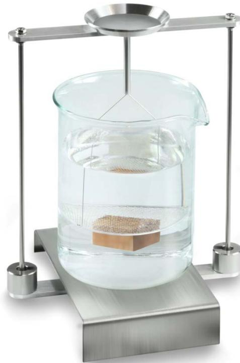
Abb.4: Wägung in Hilfsflüssigkeit
