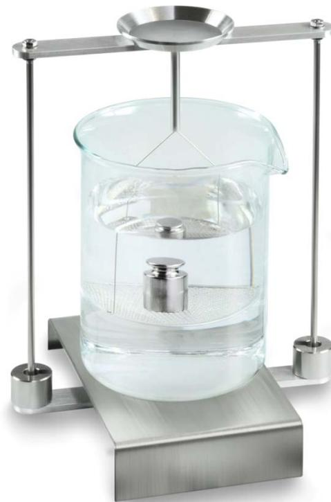
Abb.2: Wägung in Hilfsflüssigkeit
