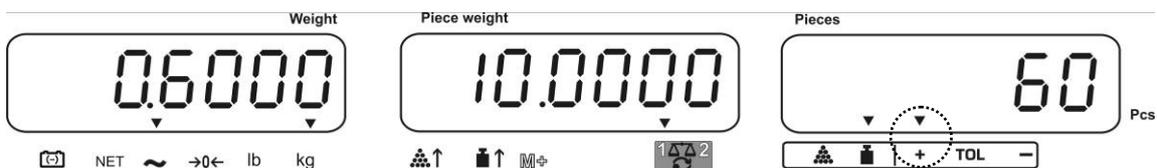
Die Information, ob das Wägegut sich innerhalb der Toleranzgrenzen befindet, kann zusätzlich noch durch ein akustisches Signal gegeben werden (Menüpunkt „BEEP“, s. Kap. 12.2)
