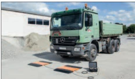
**Verwiegen von LKW, Wohnmobilen, Anhängern etc.** zur schnellen, ortsunabhängigen (Polizei-) Kontrolle von Achsgewichten zum Erkennen und Vermeiden von Fehlbelastungen oder Überlast
