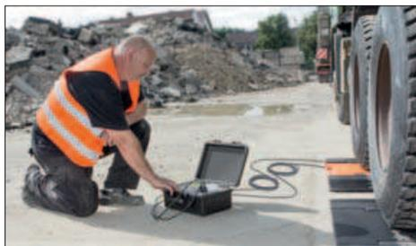
**Verwiegen von Zugmaschinen, Anhängern, Lastkraftwagen etc.** zur Kontrolle im Bereich der Anlieferung und Auslieferung von Waren & Gütern an Orten, an denen keine fest eingebaute Fahrzeugwaage zur Verfügung steht oder aus Kostengründen nicht vorhanden ist
